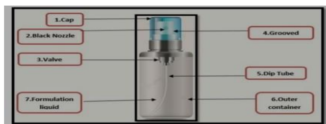
Gambar 2.3 Mekanisme Semprotan Face Mist, diambil dari (Chatur VM, et al 2021)
